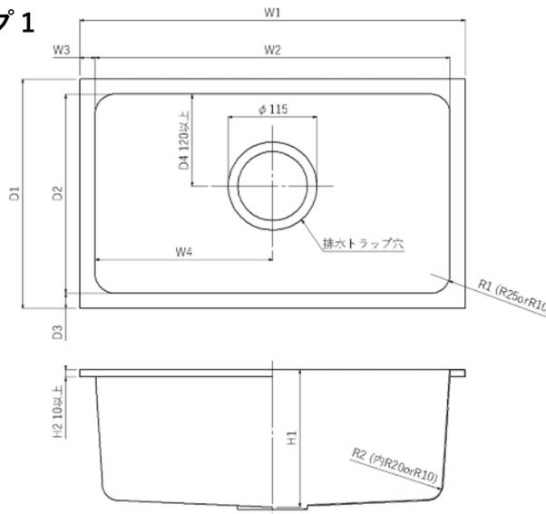
一般的な納まり方で、施工もしやすいです。突き上げる力に弱いので、排水配管はジャバラではなく、直管施工が必要です。
