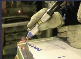
YAG(レーザー)溶接機
